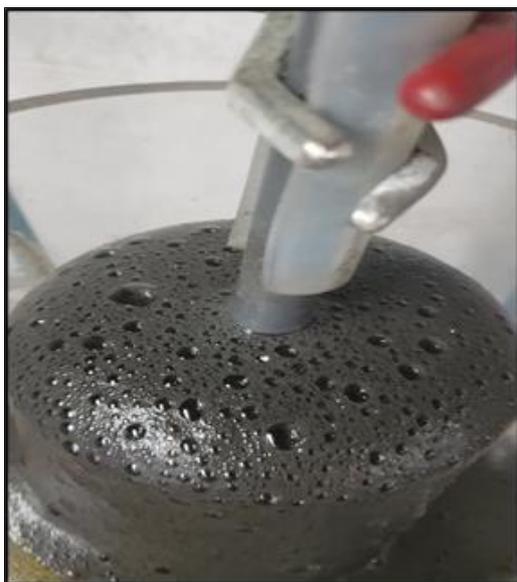
Figura N°12: Pruebas de flotación rougher
