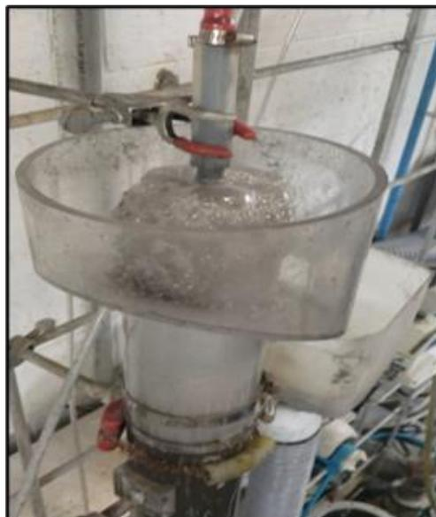
Figura N°13: Pruebas de flotación cleaner
